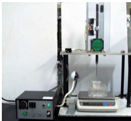
写真 簡易レオロジーメーター（左）と参加者による測定の様子（右）
